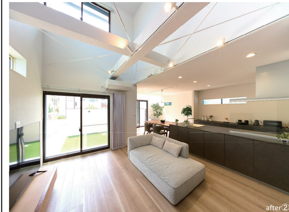
ダイニングで約12.6倍、リビングで約1.64倍の自然採光性能の向上を実現。 (実測照度を基に、外部照度の違いを補正した昼光率で比較)
