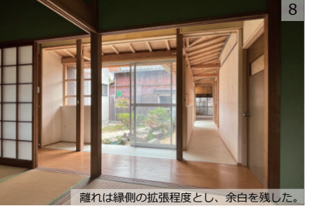
渡り廊下は腰壁以外は仕上げを省略し、中庭側を透明とすることで広く感じるようにした。
