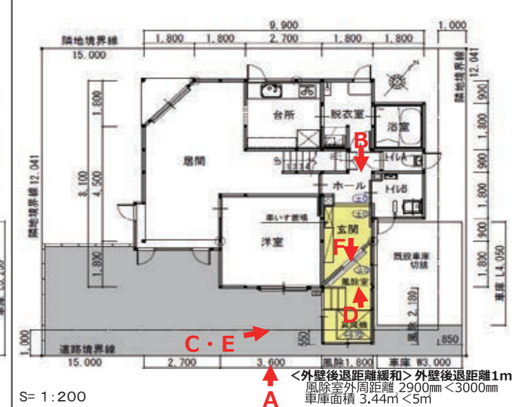
E 玄関土間と風除室内床を上げ昇降機を設置することで4つの段差を解消 介助なしでも車いすでの移動が容易にできる
