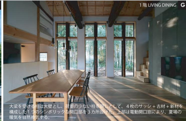
大梁を受ける柱は大壁とし、荷重の少ない柱を現しとして、4枚のサッシ+古材+新材を構成した1つのシンボリックな開口部を3カ所設けた。上部は電動開口窓により、夏場の暖気を自然換気する。
