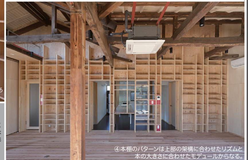
④本棚のパターンは上部の架構に合わせてリズムと本の大きさに合わせたモジュールからなる。
