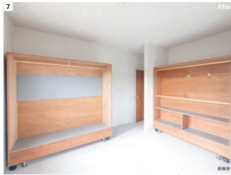
収納や障子を可動棚に変更。収納容量を確保しながら、棚を動かすことでプランを変えることができる。
