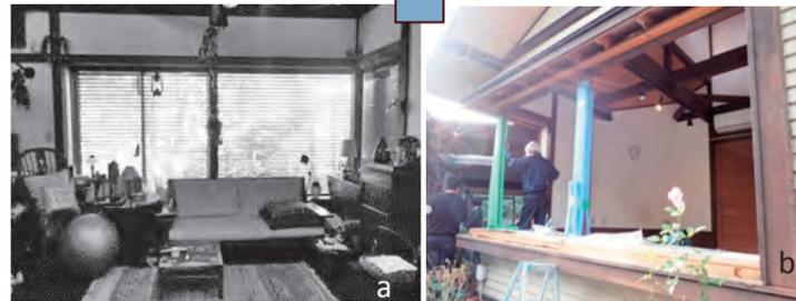
お庭の四季も豊かで、大好きなものに囲まれているお気に入りのリビング。寒さの原因だった嵌め殺しと引き違いの窓を撤去し、ウインドキャッチャーとアルミ複合LOWEガラスのサッシに取り換え。通風改善と断熱強化となった。暖房はホットカーペット+石油ストーブから、床の断熱強化と省エネAC床暖に。
