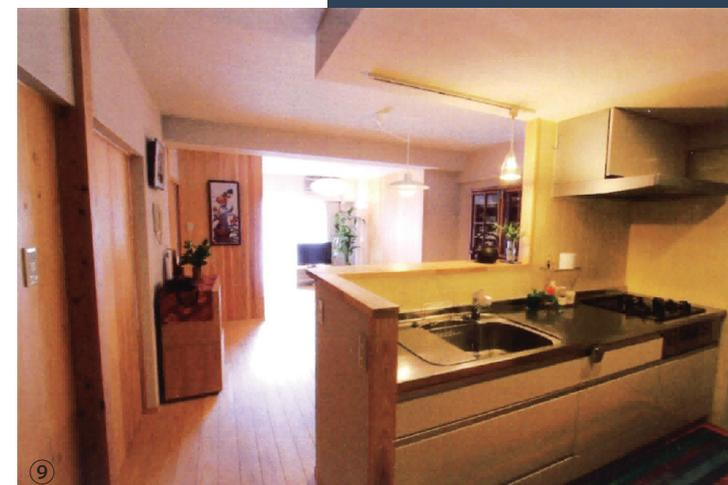
2重窓と断熱、日射効果で暖房なしでも暖かい時間が増えた。内装は杉板フローリング。火山灰による塗壁、布クロスなどの自然素材。
